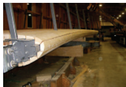
Bild 7 ... Holzbohlen an ihnen befestigt werden konnten, welche die surfbrettähnlich abgerundeten Plattenränder bilden.
