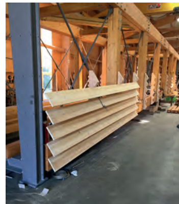
Fertigung des Stahlbaus, Vormontage der Segmente und Anbringen der Lamellen © Schmees & Lühn Holz- und Stahlgenieurbau GmbH & Co. KG
