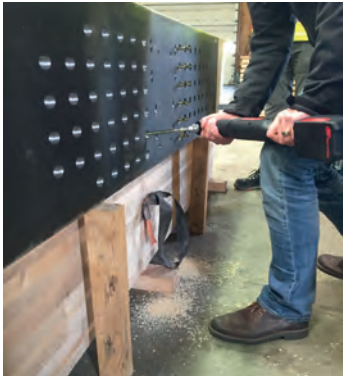
10 Versuche zum Schraubeneindrehen © Schmees & Lühn Holz- und Stahlgenieurbau GmbH & Co. KG
