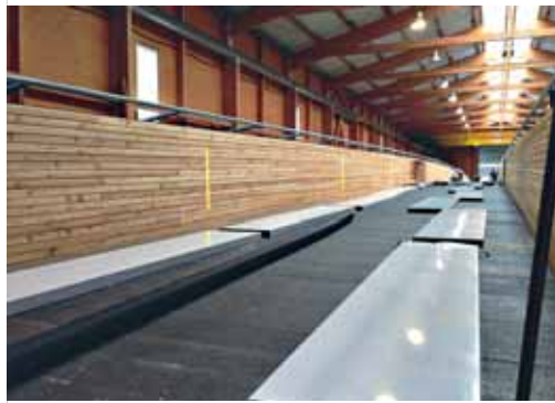
Komplette Auslegung der Roermond-Brücke im Zuge der Fertigung in der 100 m langen Halle bei Schmees & Lühn in Fresenburg
